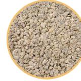
*\*L'asphalte est une combinaison, à haute température de bitume et de granulats d'asphaltes (calcaire et sable), il revêt des caractères similaires au béton bitumineux*
