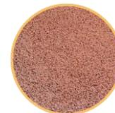
**Avantages :** Il est moins polluant que l'enrobé à chaud, plus facile de mise en œuvre et nécessite une épaisseur inférieure donc coûte moins cher pour une même surface. Comme l'enrobé à chaud il est confortable et résistant.
