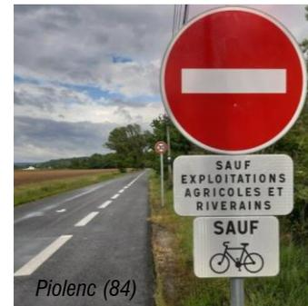
Le dispositif de la **double impasse** consiste à fermer une rue ou un chemin par des potelets ou une barrière, en créant une impasse de chaque côté. Cela limite beaucoup le trafic automobile, qui se trouve réduit à celui des riverains : cela supprime le trafic de transit. La fermeture peut être limitée à un point, ou porter sur un segment de chemin ou de route, plus ou moins long (source : AF3V).
